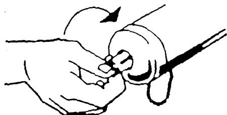
7. Cầm túi Unipak bằng hai tay theo chiều dọc. Vuốt tròn và từ từ đun túi vào nòng súng bơm. Đẩy gọn các mép túi vào và giữ vị trí vòi bơm thẳng ra ngoài, nambi giữa, đừng để vòi bơm đè lên nếp gấp.
