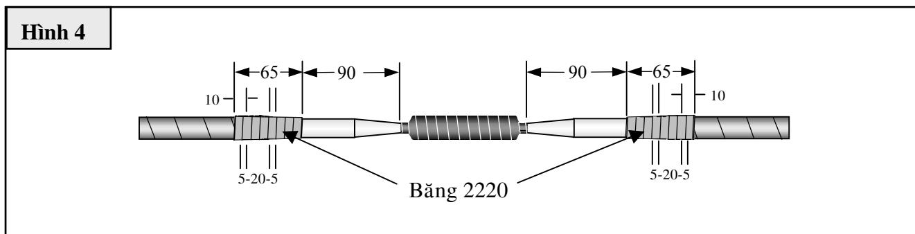
10. Dùng giẻ lau CC2 (có cung cấp) chùi sạch lớp cách điện XLPE, đừng để chất tẩy dụng vào lớp bán dẫn (hoặc băng #13). Để khô trước khi quấn băng tiếp.
