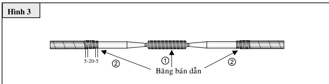
9. Quấn hai lớp băng Scotch # 2220 bắt đầu từ 10mm (cách mép cắt) trên băng đồng phủ qua lớp băng #13 vừa quấn xong, lấn qua lớp XLPE (chiều dài quấn băng #2220 là 65mm, xem hình vẽ) và quay trở lại điểm xuất phát (Hình 4).
