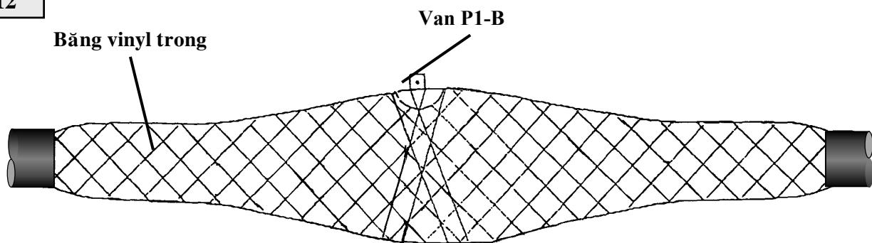
22. Quấn lên toàn bộ hộp nối bằng 2 lớp băng chỉ sợi (quấn chồng nửa). Chừa khoảng thông hơi ở hai đầu cuối hộp nối. (Hình 13).
